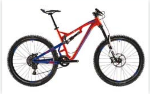
Moderne Enduro-Bikes verfügen über etwa 175 mm Federweg an Front und Heck.
